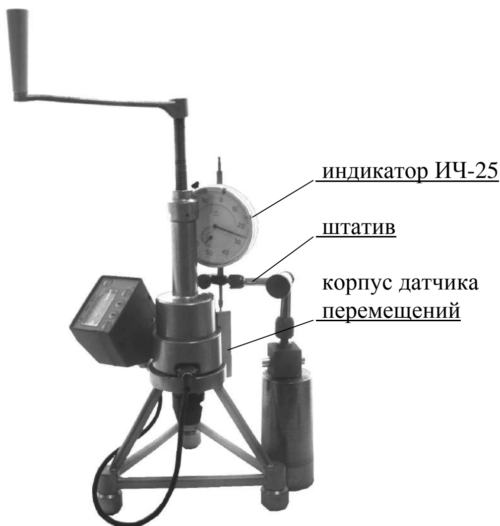
Рисунок 14 – Поверка датчика перемещений
